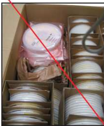
Beispielbild 1 n.i.O. Beispiel – gemischte und ungeschützte Spulen
