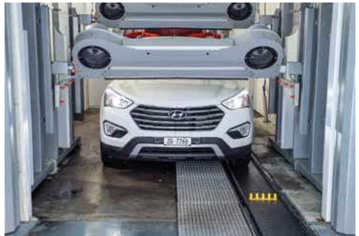
Das schwenkbare Hochleistungsgebläse trocknet sehr effizient.
